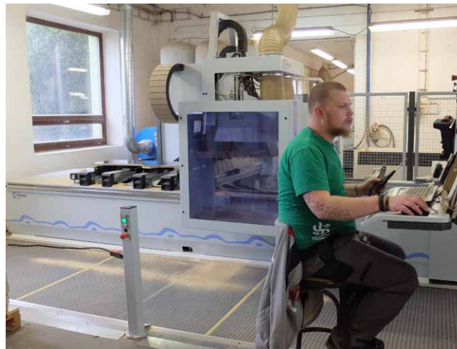
... které mezi sebou komunikují pomocí čárového kódu (nářezové centrum, olepovačka hran, CNC obráběcí centrum)
